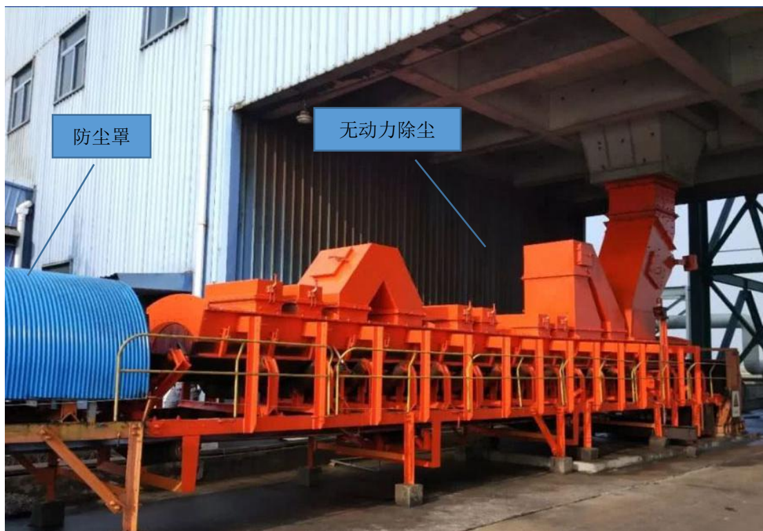
图 7-3 “无动力除尘+防尘罩”装置实物图
