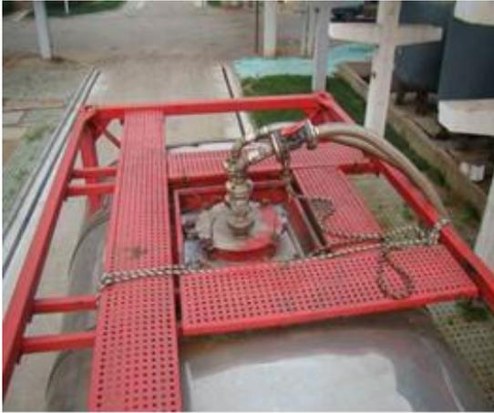
槽罐车装车平衡装置
