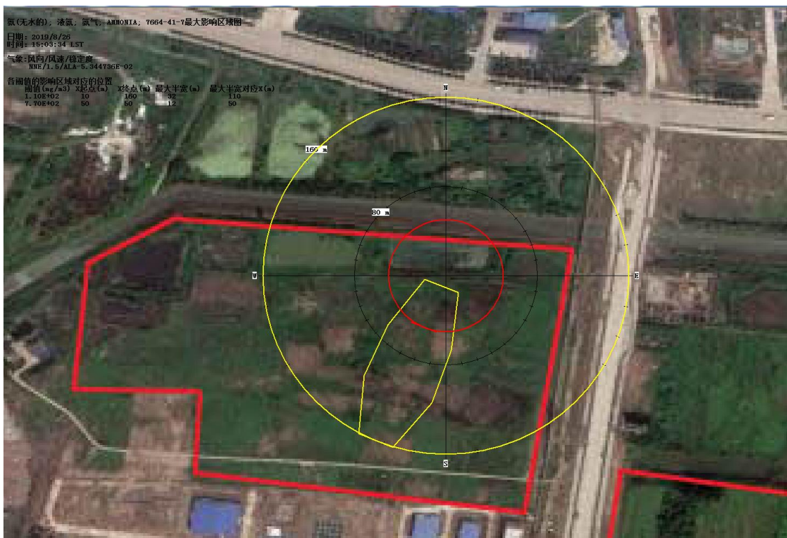
图 7-18 液氨泄露超过阈值的最大轮廓线软件截图
