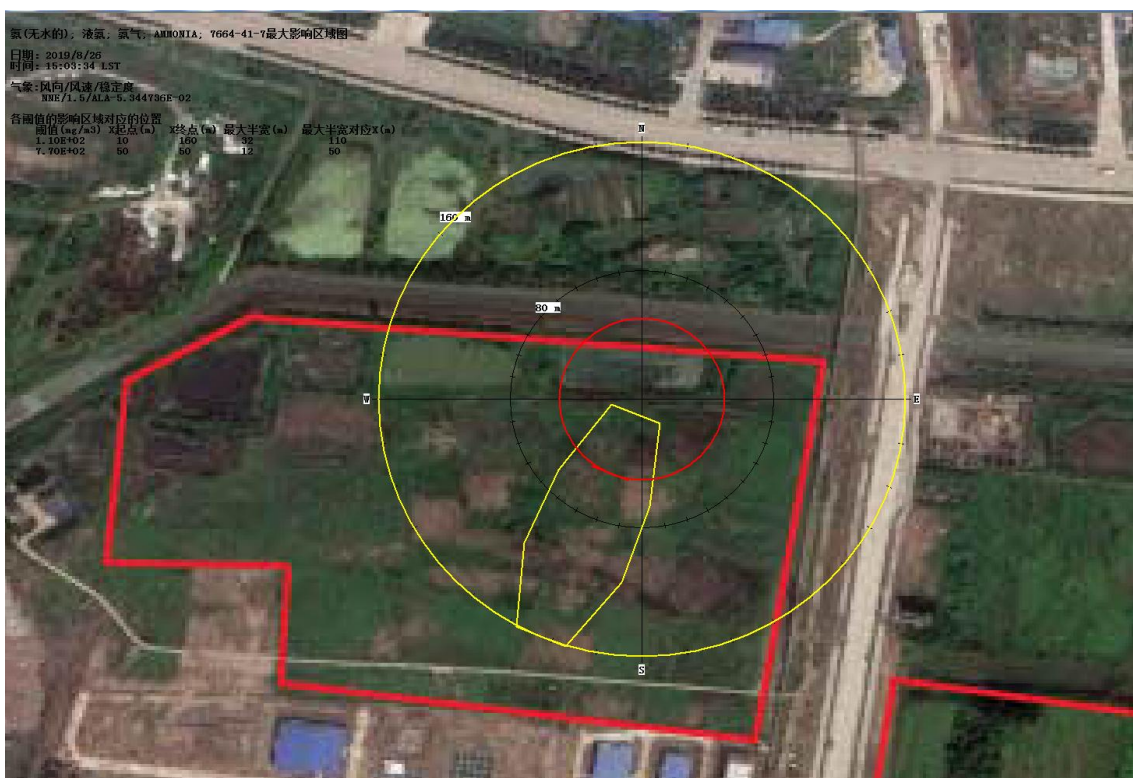
图 7-11 液氨超过阈值的最大轮廓线软件截图
