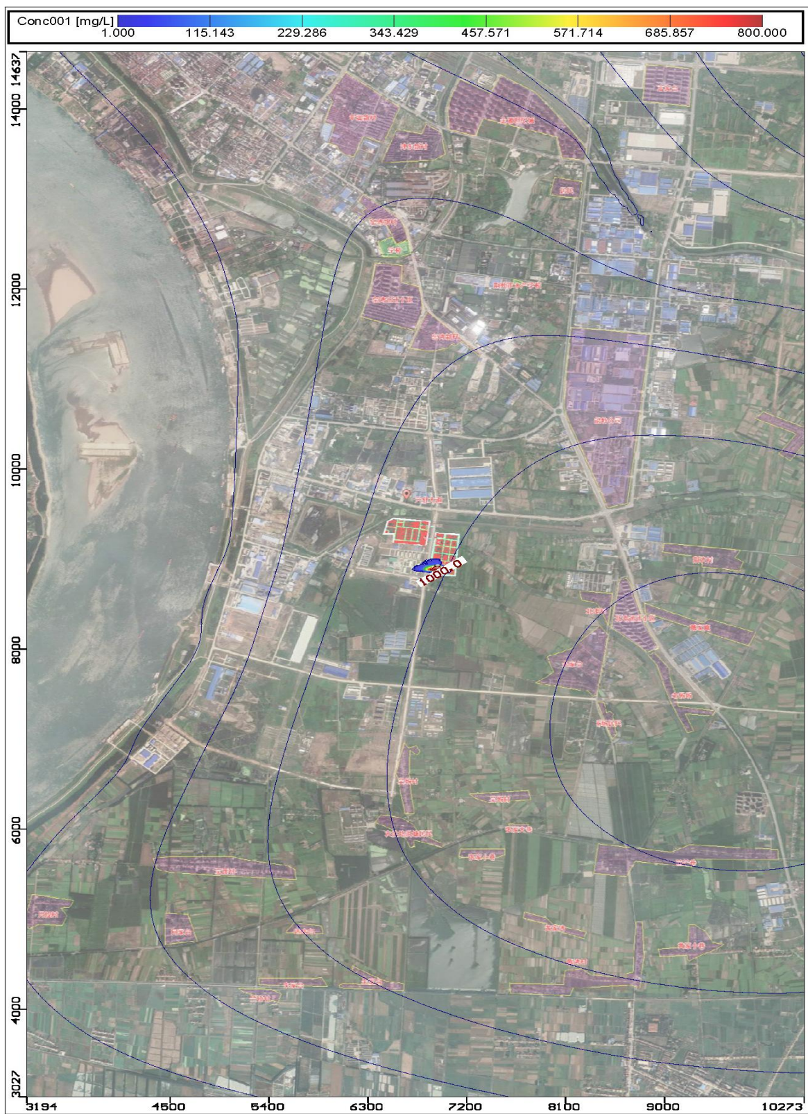
图 6-10 泄漏发生污染晕分布图 (1000 天)
