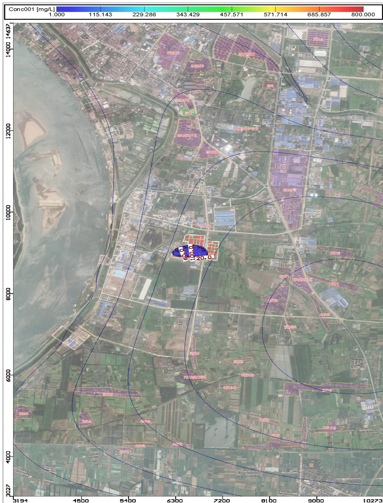
图 6-12 泄漏发生污染晕分布图 (7300 天)
