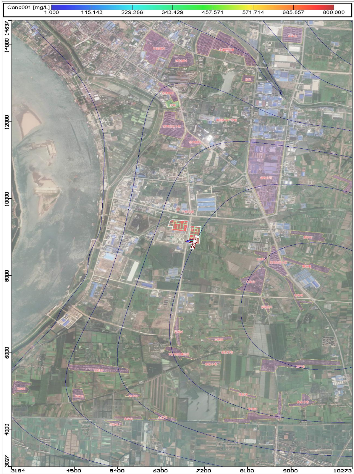
图 6-9 泄漏发生污染晕分布图（100 天）
